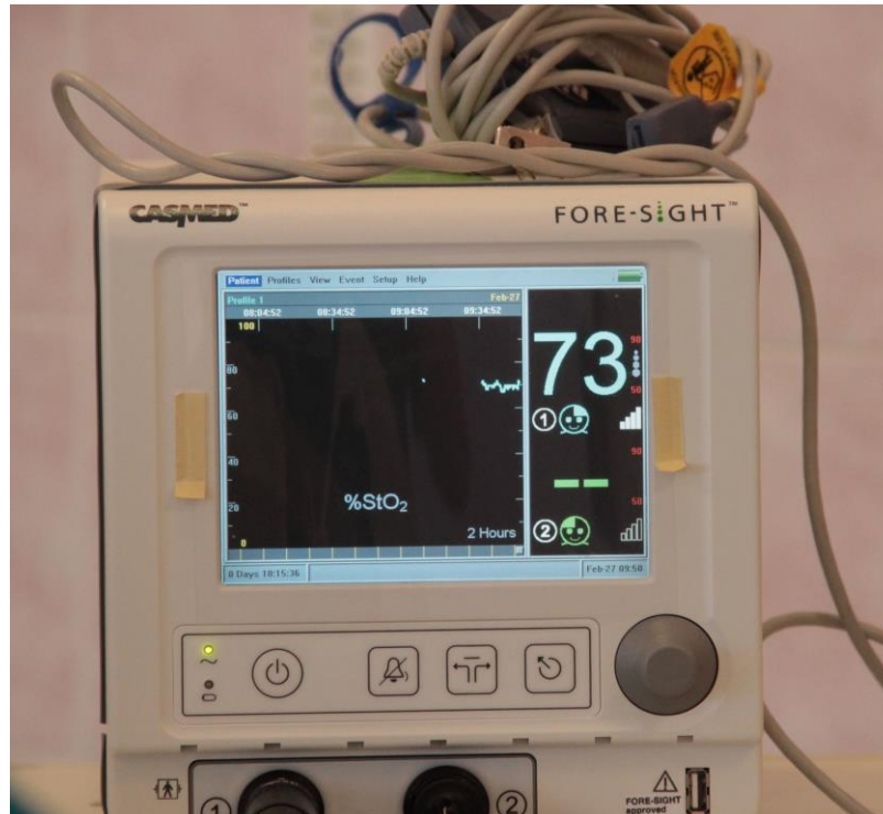
Рисунок 17. Церебральный оксиметр «Fore-Sight Elite™».
